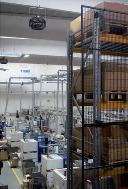
Nel nuovo stabilimento è inserito l'intero reparto di presse a iniezione verticali per co-stampaggio con macchine da 20 a 60 t che stampano sia volumi ridotti sia grandi serie.
